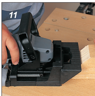
11 Ghidul, fixat pe o altă față, permite realizarea creștăturilor în bucățile tăiate la 45°.
