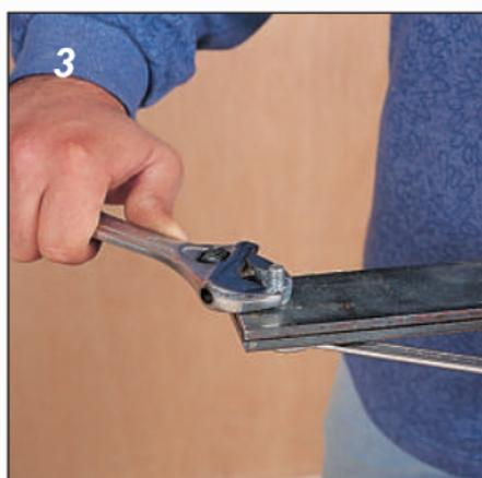
**3** Cheia inelară cu 6 sau 12 laturi se sprijină pe cele 6 fațete ale capului șurubului. Cheia inelară cu 12 laturi se sprijină pe cele 6 unghiuri ale capului șurubului.
