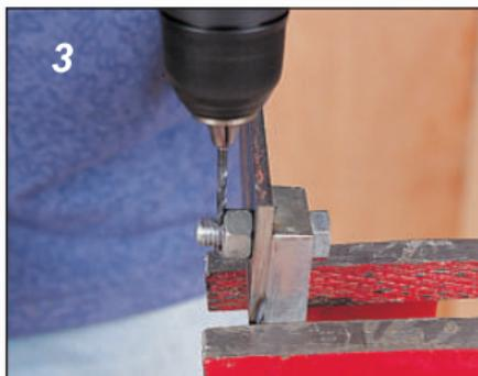
3 Introduceți opritorul/ cuiul, care trebuie să alunece, rezistând ușor și îndoiți-i capetele în jurul șurubului.
