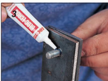
3 Pentru asamblările ce lucrează sub constrângeri puternice, rășina de blocare a piuliței evită deșurubarea, permițând totodată demontarea.
