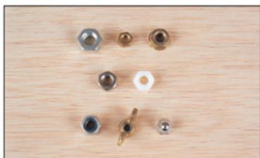
Complementul șuruburilor, piulițele preiau indicațiile de diametru pentru a se potrivi cu șuruburile. Astfel, un "șurub de 6" va primi o "piuliță de 6"!
