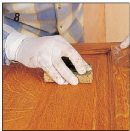
8 Clătiți suprafața decapată cu apă curată și lăsați să se usuce înainte de a aplica noul strat.
