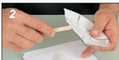
2 După ce amestecați cele două componente, întindeți-le pe suprafața care trebuie lipită și asamblați-le ținând strâns atâta timp cât să se usuce.
