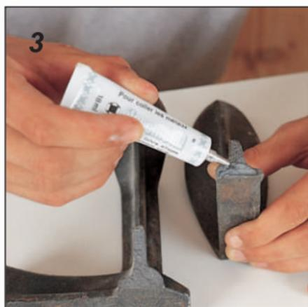
**3** Lipici cu metacrilat din două componente pentru lipiri rezistente. Întindeți lipiciul pe una din suprafețe.
