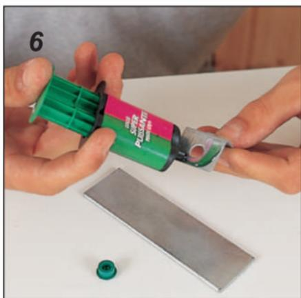
6 Lipici cu metacrilat cu două componente. Cu ajutorul siringii, se aplică ambele componente, în același timp pe suprafața respectivă.
