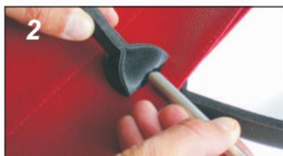
2 Lăsați suprafețele date cu lipici să se usuce fără să le puneți în contact. Aici, mânerul pensulei le ține depărtate.
