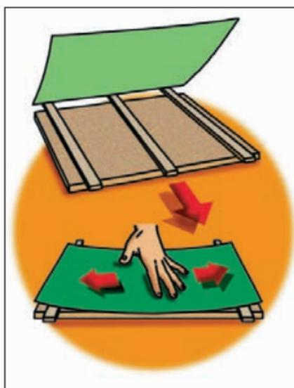
Aplicarea materialelor lamelare pe lemn se efectuează cu lipici neopren:
