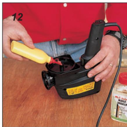
**12** Înainte de a pune aparatul la păstrare, protejați mecanismele cu ulei de vaselină.
