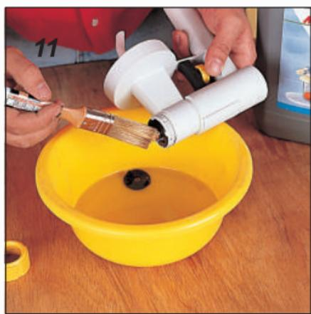
**11** În funcție de vopseaua utilizată, curătați cu grijă toate piesele cu un diluant sau cu apă.
