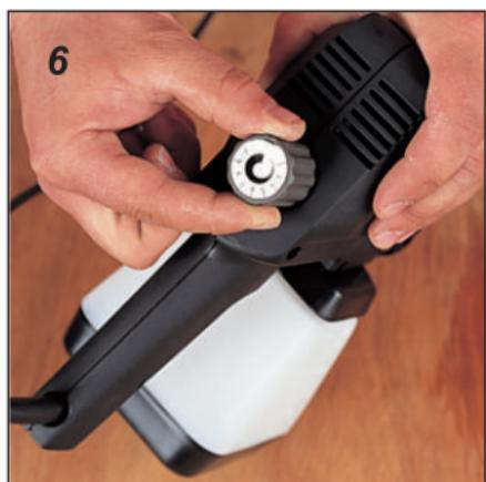
6 Reglați debitul de pulverizare, făcând un test pe ziare sau pe un carton de aruncat. Acesta depinde de produsul ce trebuie pulverizat și de distanța de pulverizare.
