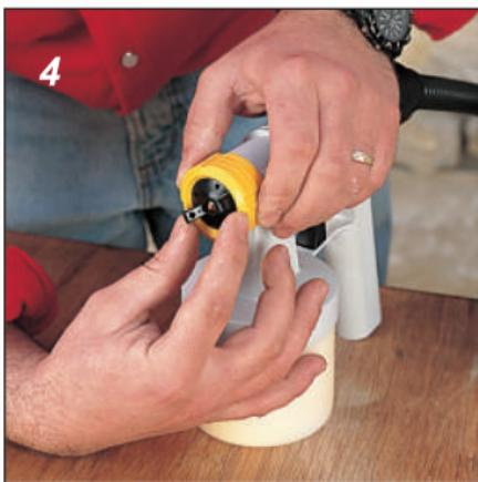
4 La pistoalele cu aer comprimat, reglajul jetului de aer se face prin orientarea duzei.
